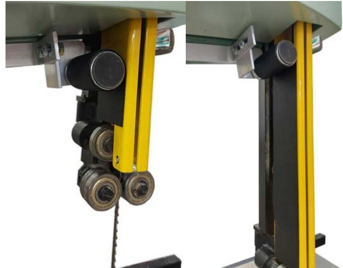
Rideau protecteur rétractable pour guide de lame de scie à ruban verticale. Facile à installer, il est fabriqué à partir d'une seule pièce à fixer sur la partie supérieure et inférieure du guide de scie à ruban existant.
